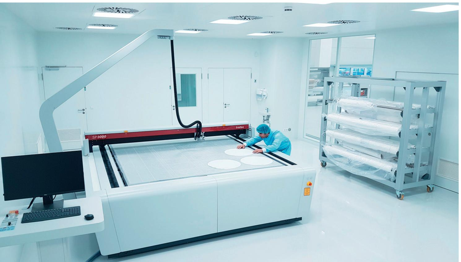
Der Flachbett-Laser im Reinraumeinsatz: Die Absaugung und Kühlung sind in der Zwischendecke außerhalb des Reinraums installiert. © Kögel
